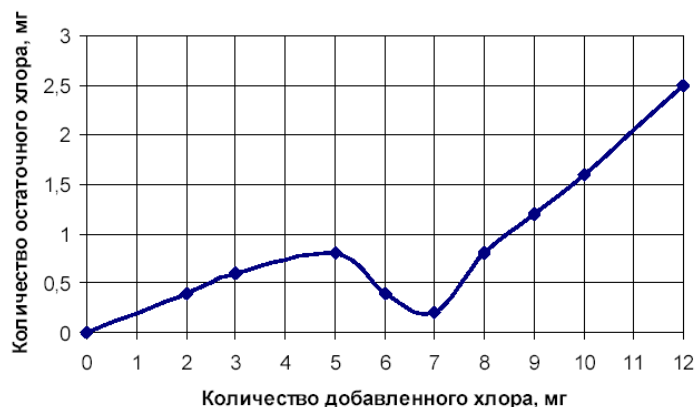
Рис. 14.2. Кривая йодометрического титрования активного хлора
