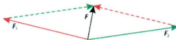
Рисунок 4.1 – Векторная сумма сил (параллелограмм сил)
