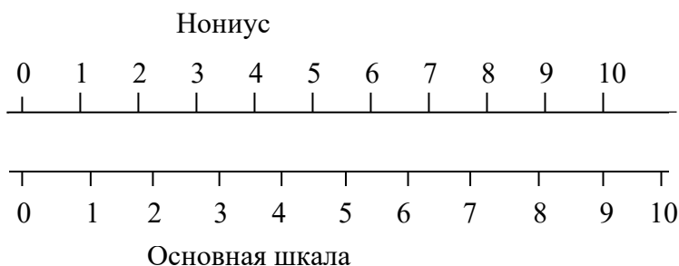
Рисунок 2.1 – Нониус и основная шкала
