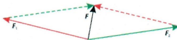
Рисунок 4.1 – Векторная сумма сил (параллелограмм сил)
