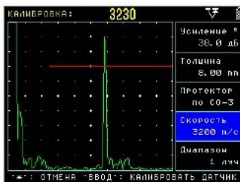
Рисунок 6.9 – Калибровка скорости в образце
