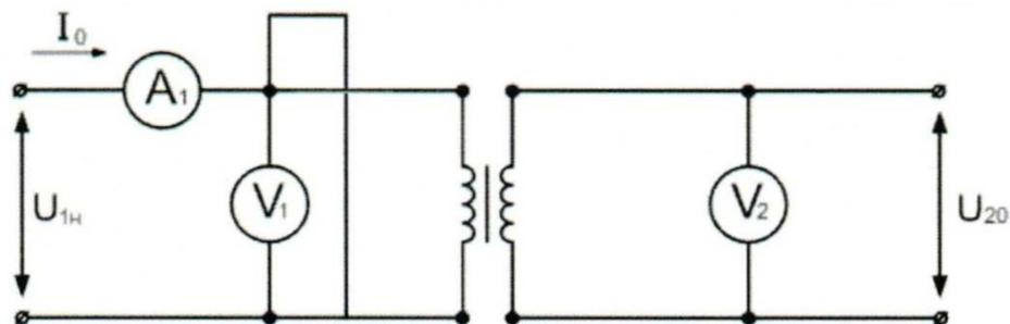
Рисунок 12.1 – Схема опыта холостого хода однофазного трансформатора
