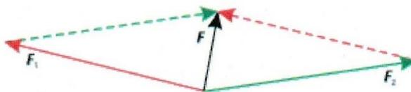
Рисунок 4.1 – Векторная сумма сил (параллелограмм сил)
