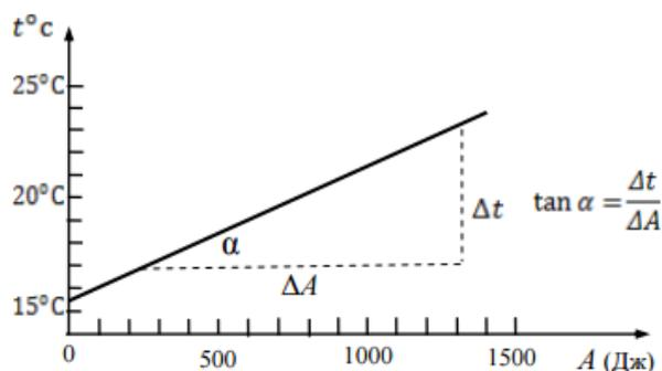
Рисунок 6.3 – График зависимости температуры от совершенной работы
