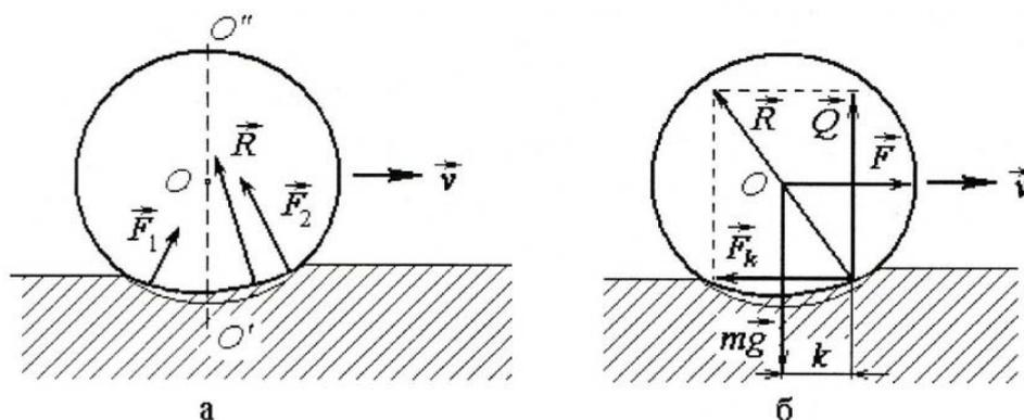
Рисунок 5.2 – а) Возникновение силы в случае неупругой деформаций катящегося тела и поверхности; б) движение цилиндрического тела массой  $m$  по горизонтальной поверхности под действием внешней силы  $\bar{F}$ .
