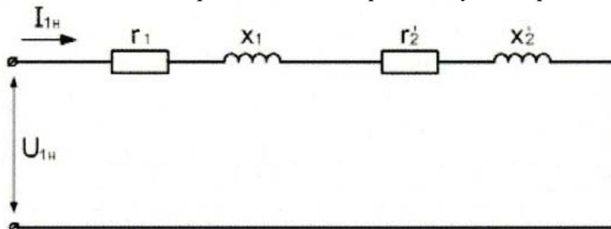
Рисунок 12.4 – Схема замещения при опыте короткого замыкания
