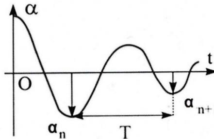
Рисунок 3.2 – Затухающие колебания при малом сопротивлении
