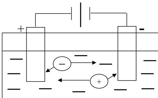
Рисунок 9.1 Схема электролизёра
