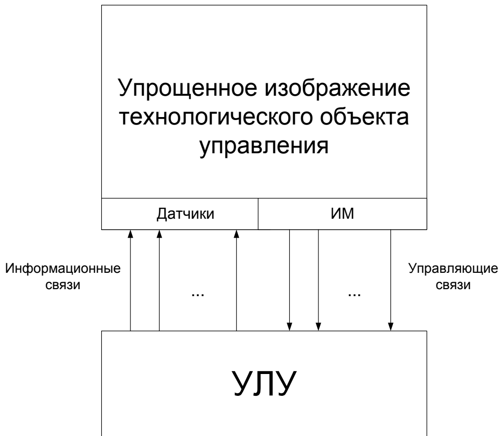
Рисунок 2. Структурная схема системы логического управления
