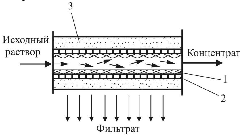
Рис. 4. Трубчатый элемент
