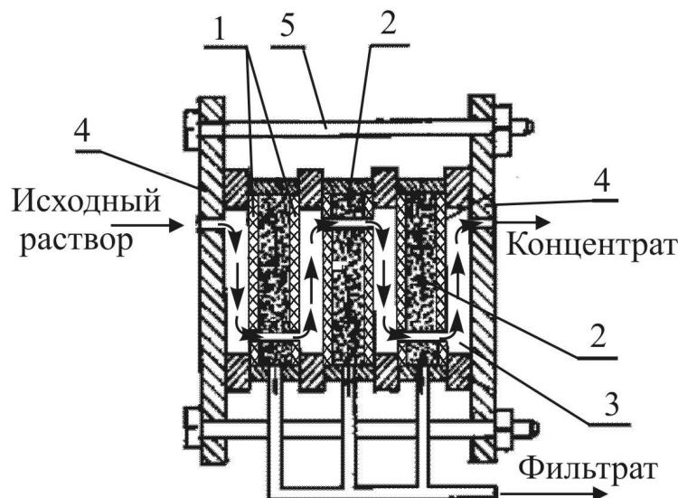
Рис. 3. Мембранный аппарат типа
