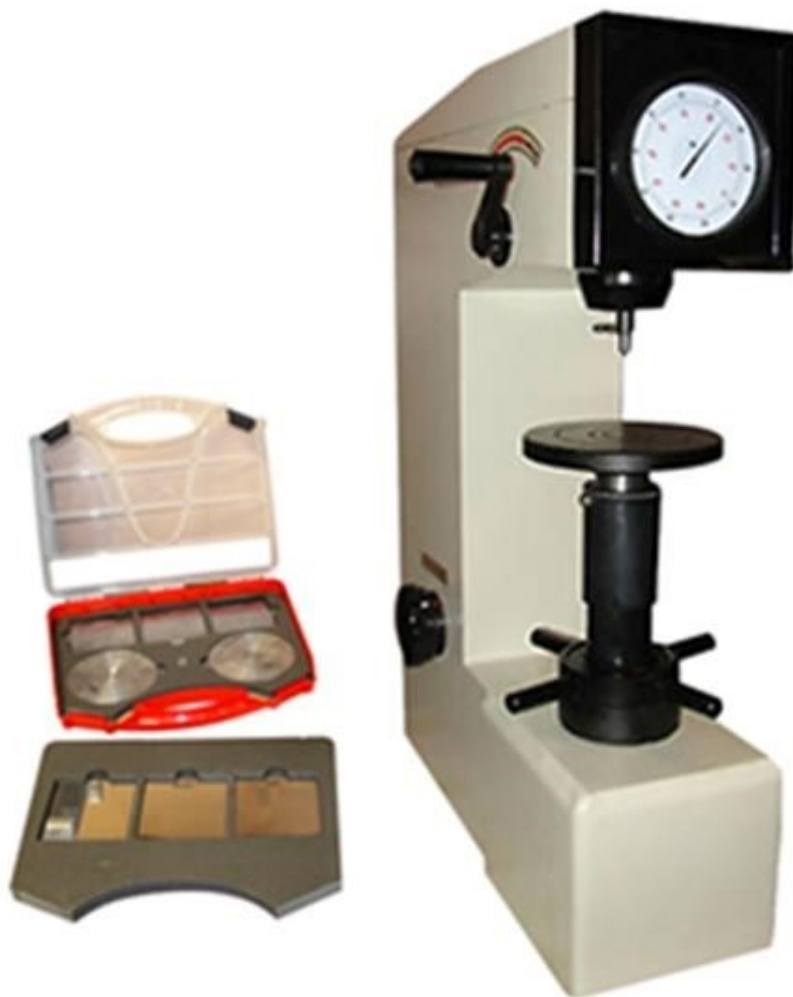
Рисунок 4.3 – Общий вид лабораторной установки для определения твердости по методу Роквелла.
