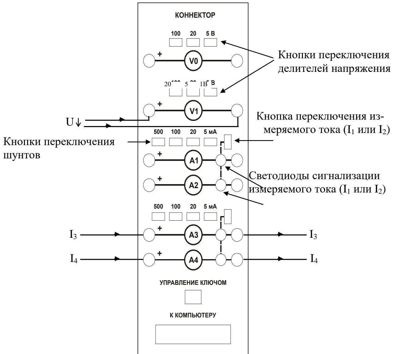
Рисунок 1 – Общий вид лицевой панели коннектора
