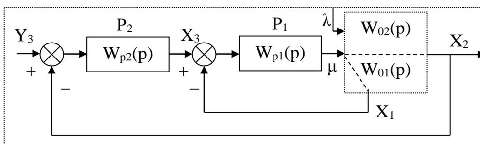
Рисунок 1 – Каскадная САУ со стабилизирующим регулятором
