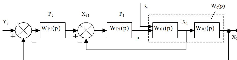
Рисунок 2 – Каскадная САУ со стабилизирующим регулятором (вариант 2)
