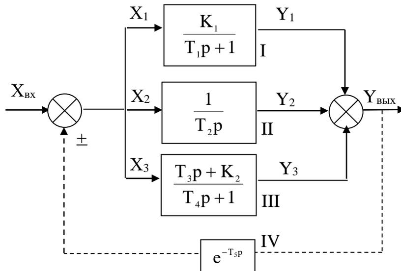
Рисунок 2 – Структурная схема АСР при параллельном соединении звеньев и наличии обратной связи
