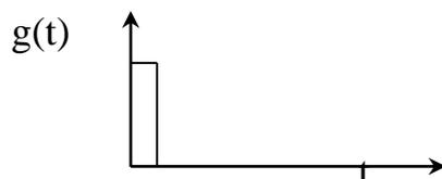
Рисунок 1.2 – Графическое изображение единичного импульсного воздействия
