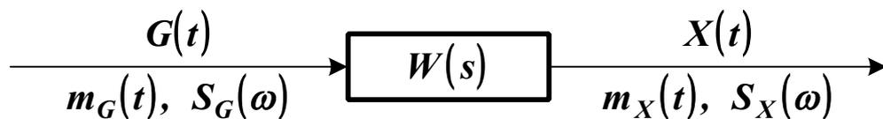
Рисунок 2.3 – Линейная система с передаточной функцией
