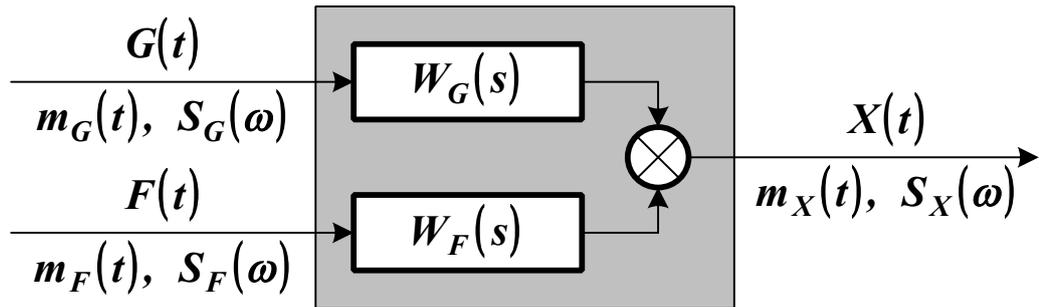
Рисунок 2.5 – Система, находящаяся под влиянием двух случайных воздействий
