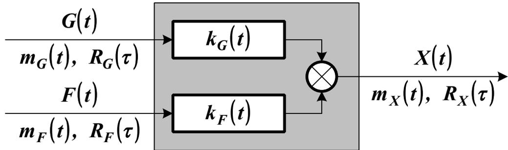
Рисунок 2.2 – Система, находящаяся под влиянием двух случайных воздействий
