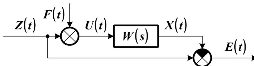
Рисунок 3.5 – Схема воспроизведения полезного сигнала
