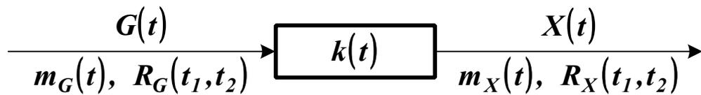
Рисунок 2.1 – Линейная система с весовой функцией  $k(t)$ , находящаяся под влиянием случайного воздействия
