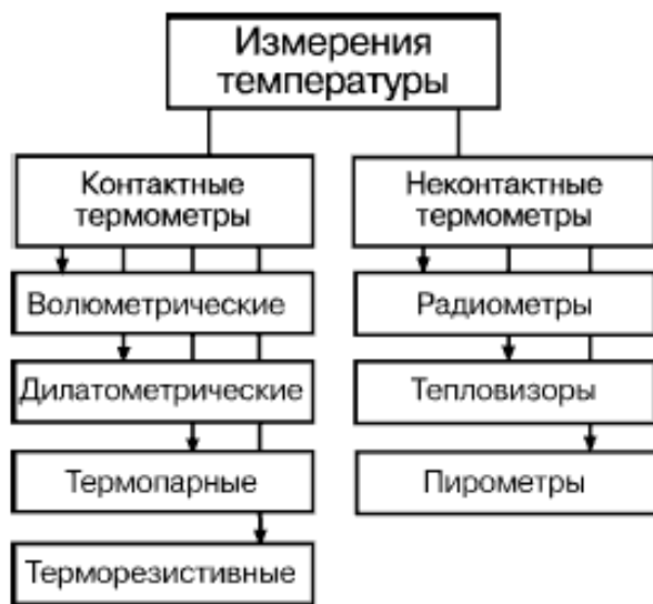
Рис.2.1. Классификация методов измерения температуры
