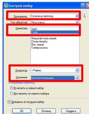
14. Линии слоя Вспомогательный будут выделены, следует нажать клавишу del на клавиатуре для их удаления.
