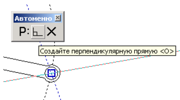
Рисунок 75 – Построение перпендикулярной прямой
