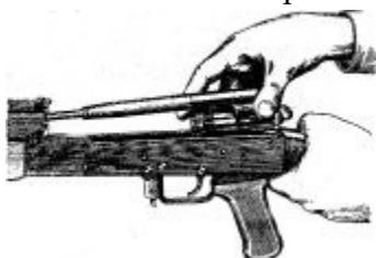
**Отделить затвор от затворной рамы.** Взять затворную раму в левую руку затвором
