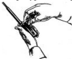
**Отделить газовую трубку со ствольной накладкой.** Удерживая автомат левой рукой, правой рукой надеть пенал принадлежности прямоугольным отверстием на выступ замыкателя газовой трубки. Повернуть замыкатель от себя до вертикального положения и снять газовую трубку с патрубком газовой камеры.
