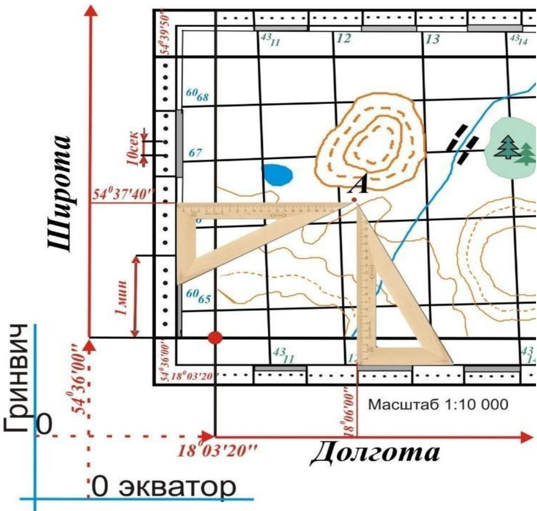
Определение прямоугольных координат точки по карте Прямоугольные координаты точки ( $X$ ,  $Y$ ) по карте определяют в квадрате километровой сетки следующим образом:
