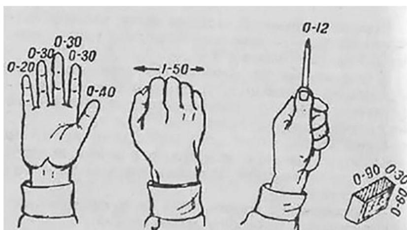
**Определение расстояний по линейным размерам** предметов заключается в следующем. С помощью линейки, расположенной на расстоянии 50 см от глаза, измеряют в миллиметрах высоту (ширину) наблюдаемого предмета. Затем действительную высоту (ширину) предмета в сантиметрах делят на измеренную по линейке в миллиметрах, результат умножают на постоянное число 5 и получают искомую высоту предмета в метрах:
