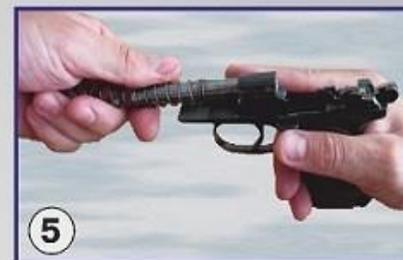
5 Вращательным движением снять со ствола возвратную пружину (рис. 5). Удерживая рамку правой рукой за рукоятку, левой рукой отвести возвратную пружину вперед и снять со ствола.
