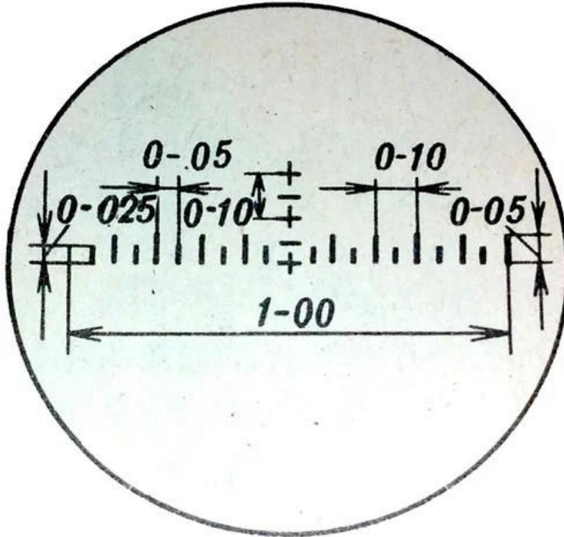
Угловую величину предмета в тысячных можно определить с помощью полевого бинокля или другого прибора наблюдения. В поле зрения бинокля имеется угломерная сетка, которая в свою очередь имеет взаимно перпендикулярные угломерные шкалы. Величина одного большого деления шкалы соответствует 10 тысячным (0-10), малого — 5
