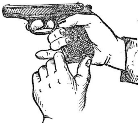
Рис. 3. Извлечение магазина из основания рукоятки Проверить, нет ли в патроннике патрона, для чего выключить предохранитель (опустить флажок вниз), отвести левой рукой затвор в заднее положение, поставить его на затворную задержку и осмотреть патронник. Нажав большим пальцем правой руки на затворную задержку, отпустить затвор.
