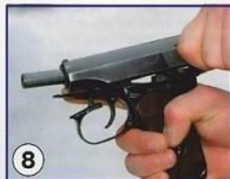
8 Опустить задний конец затвора на рамку так, чтобы продольные выступы затвора поместились в пазах рамки, и, прижимая затвор к рамке, отпустить его. Затвор под действием возвратной пружины энергично возвращается в переднее положение. Включить предохранитель (поднять флажок вверх).
