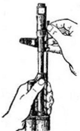
**Отделить у автомата дульный тормоз-компенсатор.** Утопить отверткой фиксатор дульного тормоза-компенсатора. Свернуть дульный тормоз-компенсатор с резьбового выступа основания мушки (со ствола), вращая его против хода часовой стрелки. **Отделить крышку ствольной коробки.** Левой рукой обхватить шейку приклада, большим пальцем этой руки нажать на выступ направляющего стержня возвратного механизма, правой рукой приподнять вверх заднюю часть крышки ствольной коробки и отделить крышку.
