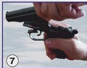
7 Присоединить затвор к рамке. Удерживая рамку за рукоятку в правой руке, а затвор в левой, ввести свободный конец возвратной пружины в канал затвора (рис. 7) и отвести затвор в крайнее заднее положение так, чтобы дульная часть ствола прошла через канал затвора и выступила наружу.
