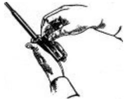
**Отделить газовую трубку со ствольной накладкой.** Удерживая автомат левой рукой, правой рукой надеть пенал принадлежности прямоугольным отверстием на выступ замыкателя газовой трубы. Повернуть замыкатель от себя до вертикального положения и снять газовую трубку с патрубка газовой каморы.
