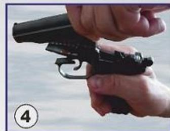
4 Левой рукой отвести затвор в крайнее заднее положение и, приподняв его задний конец, дать ему возможность продвинуться вперед под действием возвратной пружины. Отделить затвор от рамки (рис. 4) и поставить спусковую скобу на свое место.
