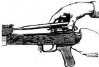
**Отделить затвор от затворной рамы.** Взять затворную раму в левую руку затвором
