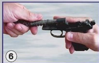
6 Надеть на ствол возвратную пружину (рис. 6). Взяв рамку за рукоятку в правую руку, левой рукой надеть возвратную пружину на ствол обязательно тем концом, в котором крайний виток имеет меньший диаметр по сравнению с другими витками.
