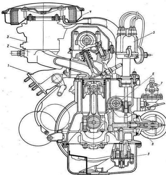
Рисунок 3.2 – Двигатель внутреннего сгорания в разрезе
