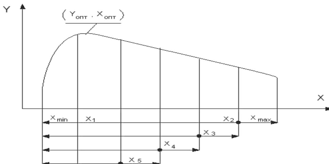
Рисунок 3.10 – Схема поиска экстремума по методу Фибоначчи
