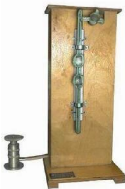
Рис. 2.3. Прибор Товарова – измерение удельной поверхности порошков фильтрацией атмосферного воздуха.
