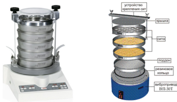
Рис. 2.1. Внешний вид и конструкция современного ситового анализатора.
