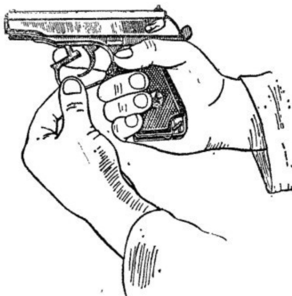
Рис. 4. Оттягивание спусковой скобы
