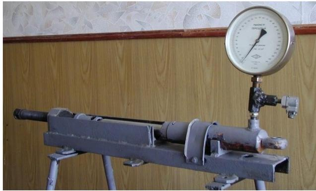
Рис. 3.4. Тарировочный стенд
