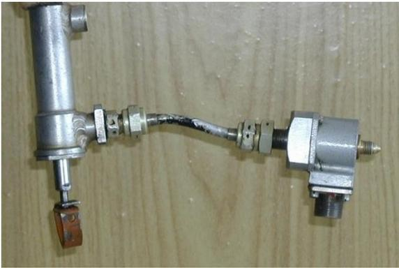
Рис. 3.3. Датчик давления ДТ-80Т
