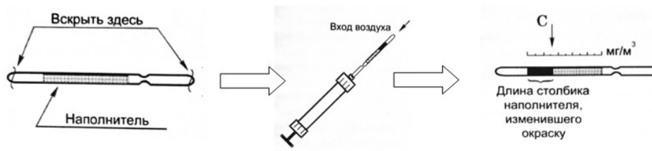
Рисунок 32. Схема определения концентрации диоксида углерода с помощью индикаторных трубок
