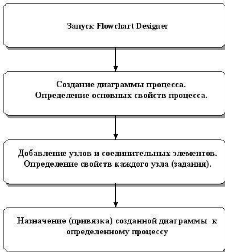
Рис. 24. Схема основных этапов создания графика WorkFlow
