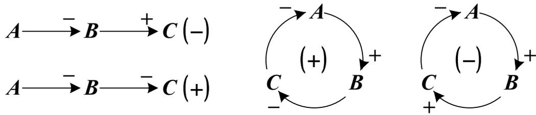
Рисунок 1.1 — Полярность сложных связей и контуров
