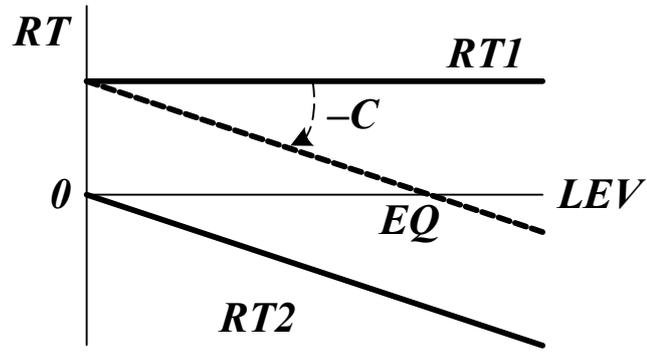
Рисунок 1.2 — Нагрузочная характеристика системы с самовыравниванием
