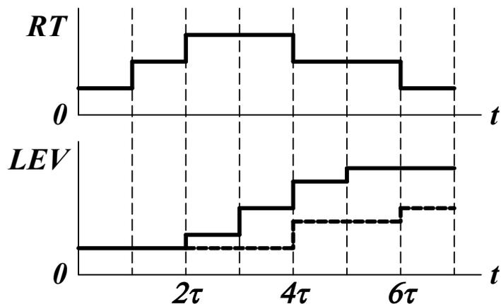
Рисунок 1.3 — Влияние величины шага моделирования на точность моделирования
