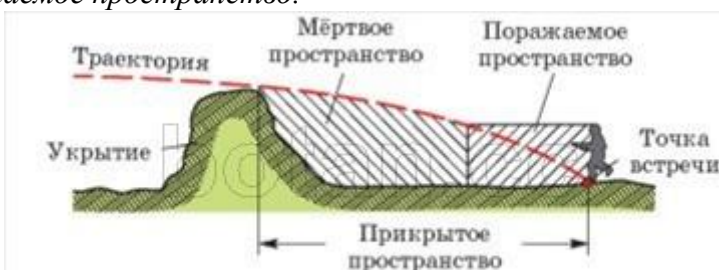
Рис. 52. Прикрытое, поражаемое и мёртвое пространство
