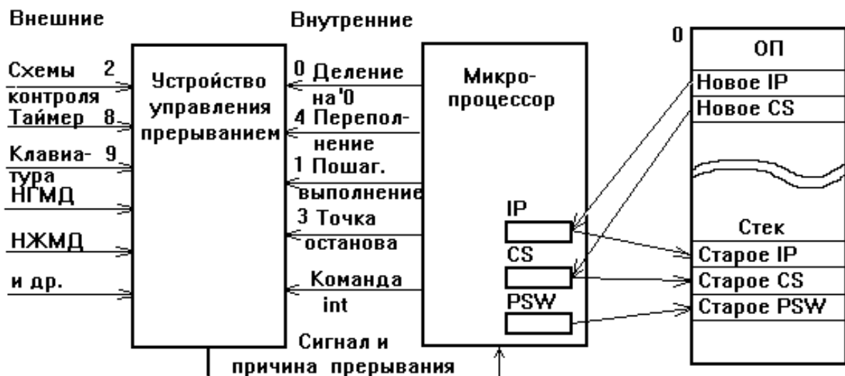
Рисунок 4.1 – Система обработки прерываний.
