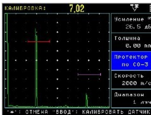
Рисунок 6.7 – Калибровка наклонного преобразователя по образцу СО-3
