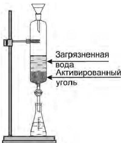
Рисунок 12. Установка для очистки воды адсорбцией
