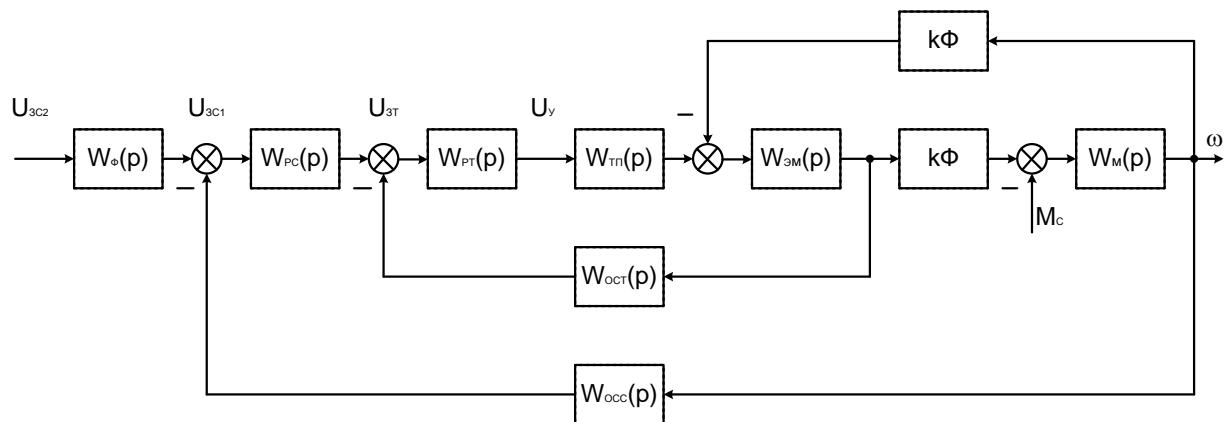
Рисунок 5.3 – Структурная схема системы электропривода
