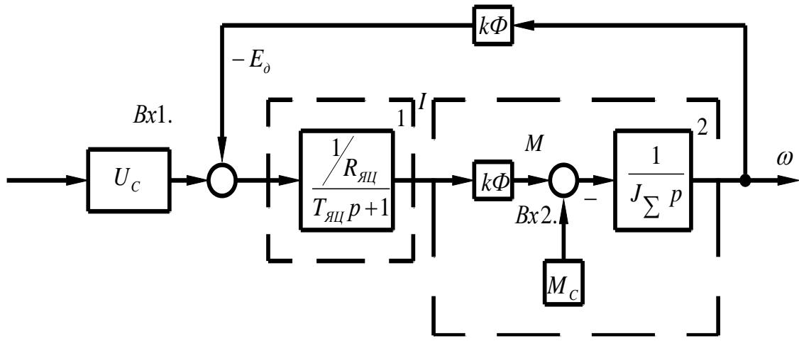
Рисунок 1.1 – Структурная схема двигателя постоянного тока
