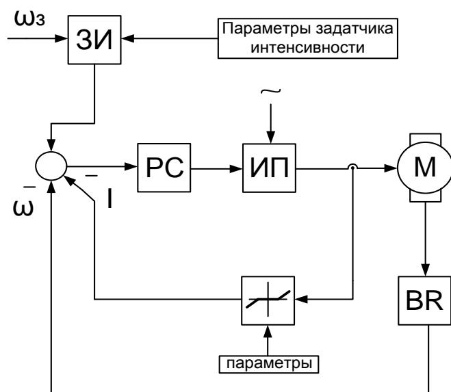
Рисунок 5.4 – Функциональная схема одноконтурной системы регулирования координат:  $\omega_3$  – задание скорости,  $\omega$  – текущая скорость, ЗИ – залатчик интенсивности, РС – регулятор скорости, ИП – источник регулируемого напряжения постоянного тока, М – двигатель, ВР – тахогенератор
