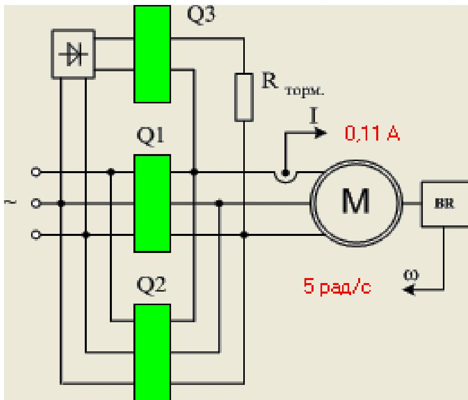
Рисунок 3.1 – Функциональная схема включения реверсивного асинхронного электропривода с возможностью динамического торможения и торможения противовключением  $B$  — выпрямитель;  $Q1$  — блок контакторов для включения электродвигателя  $M$  вперед;  $Q2$  — блок контакторов для включения электродвигателя назад;  $Q3$  — блок контакторов для перевода электродвигателя в режим динамического торможения;  $BR$  — тахогенератор
