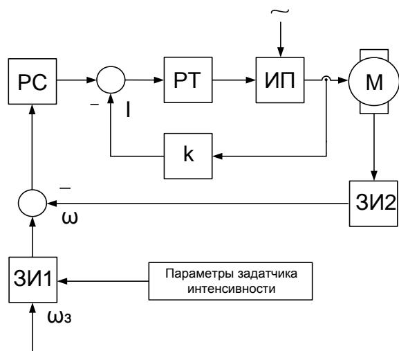
Рисунок 5.1 – Функциональная схема двухконтурной системы регулирования координат: ЗИ1- задатчик интенсивности по сигналу задания скорости, ЗИ2- задатчик интенсивности по сигналу обратной связи по скорости, РС –регулятор скорости, РТ – регулятор тока, ИП – источник регулируемого напряжения постоянного тока, М – двигатель постоянного тока, К – коэффициент обратной связи по току.
