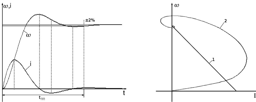
Рисунок 1.2 – Графики переходных процессов (а) и соответствующие им электромеханические характеристики (б) двигателя независимого возбуждения
