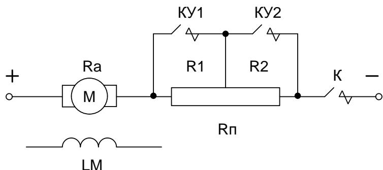
Рисунок 2.1 – Принципиальная схема силовой части реостатного пуска
