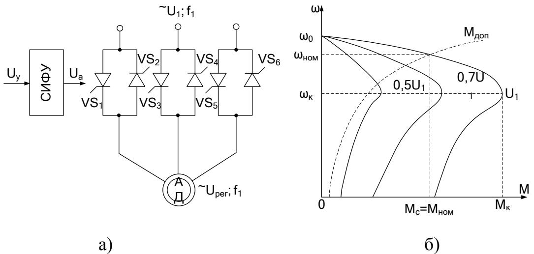
Рисунок 4.1 – Система ТРН-АД (а) и ее характеристики (б)
