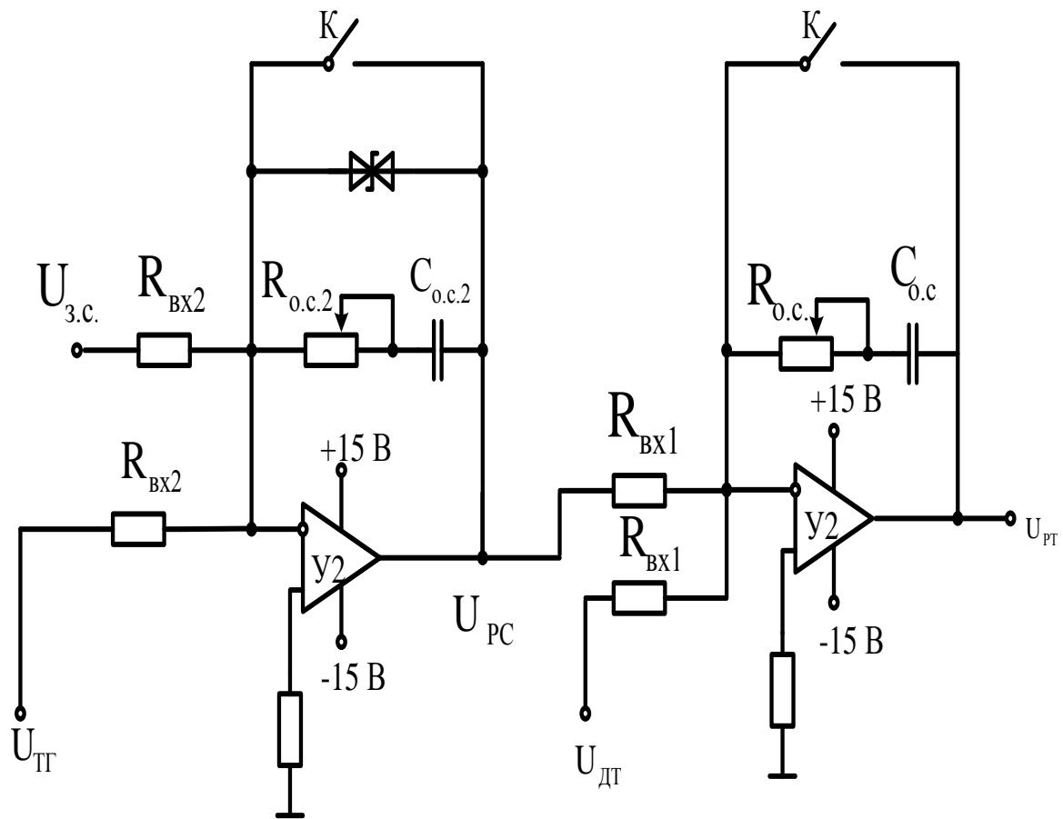
Рисунок 5.2 – Схемы аналогового исполнения РС и РТ
