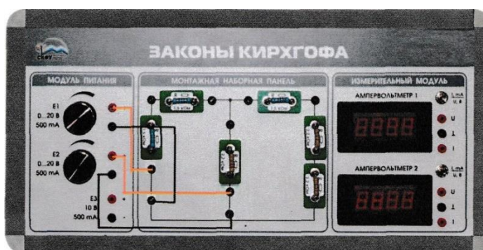
Рисунок 14.2 – Электрическая схема эксперимента
