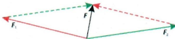
Рисунок 4.1 – Векторная сумма сил (параллелограмм сил)
