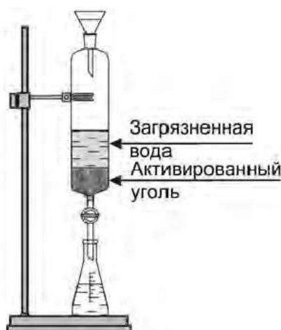
Рисунок 12. Установка для очистки воды адсорбцией
