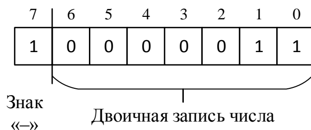
Рис. 8. Представление числа -3 в прямом коде
