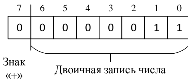
Рис. 7. Представление числа 3 в прямом коде
