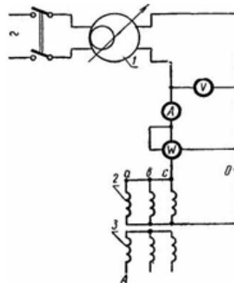
Рис. 3.2. Схема сушки трансформатора токами нулевой последовательности:
