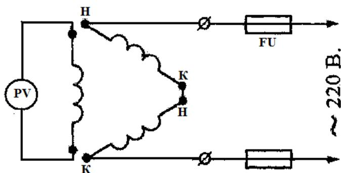
Рис.2 Электрическая схема для определения начала и конца обмотки фаз.
