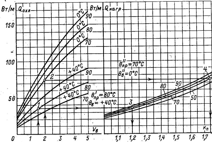
Рис. 1.2. Номограммы зависимости тепловых потерь на охлаждение
