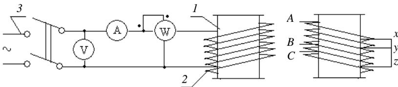
**Рис. 3.1.** Схема сушки трансформатора при помощи намагничивающей обмотки:
