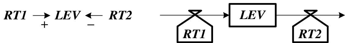
Рисунок 1.4 — Диаграмма причинно-следственных связей и диаграмма потоков и уровней для однопоточной системы
