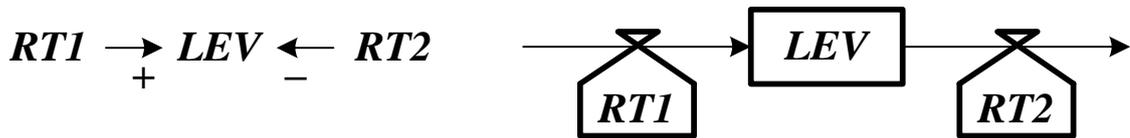
Рисунок 1.4 — Диаграмма причинно-следственных связей и диаграмма потоков и уровней для однопоточной системы
