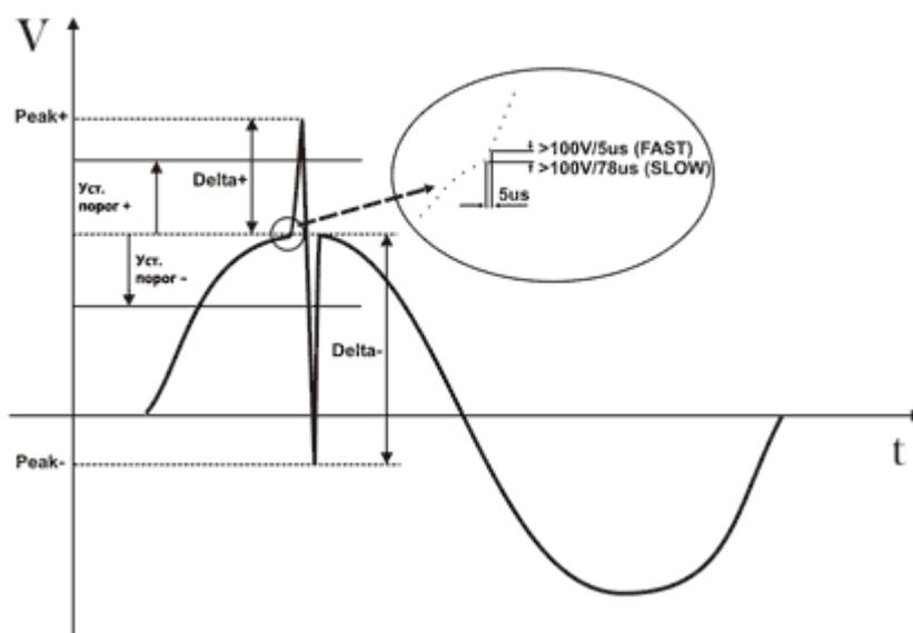
Рисунок 2: Типичный импульс напряжения (частота 50 Гц)
