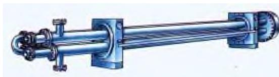
Рисунок 4.1 – Общий вид теплообменника «труба в трубе»
