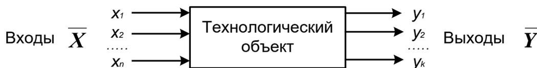
Рисунок 6.1 – Изображение технологического объекта в виде «черного ящика»
