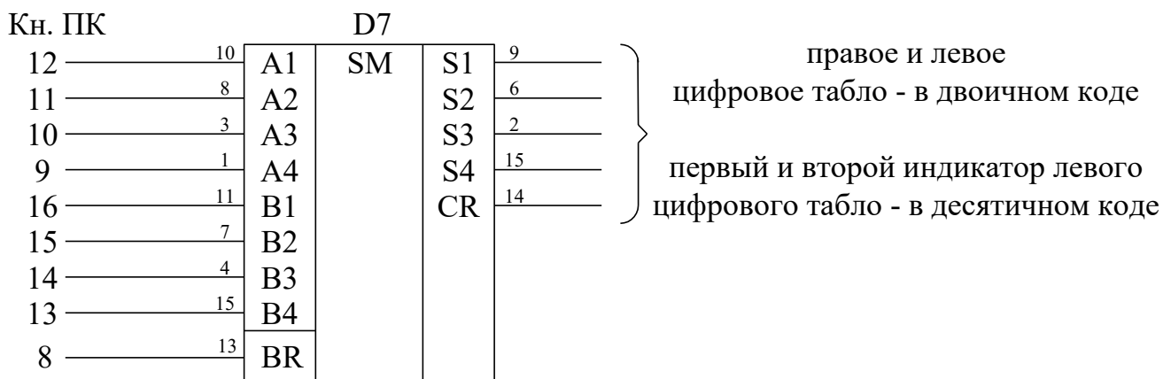
Рисунок 7.4 – Функциональная схема установки для исследования цифрового сумматора
