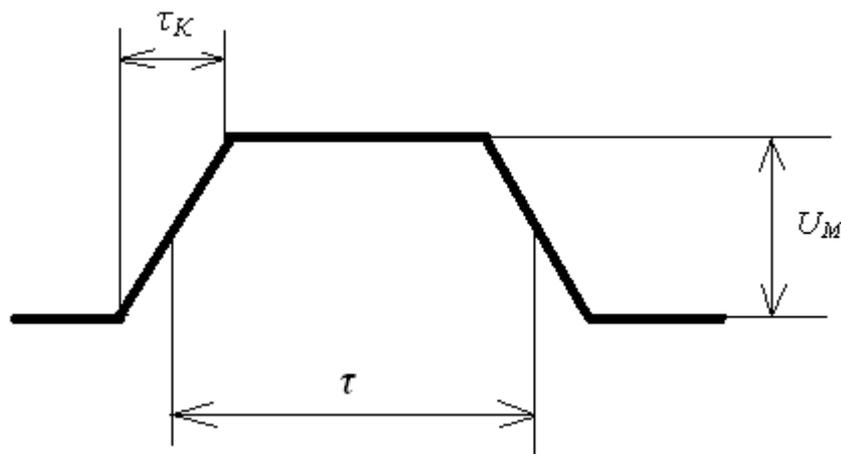
Рисунок 2 – Трапецевидный импульс
