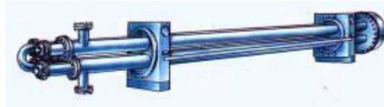
Рисунок 1 – Общий вид теплообменника «труба в трубе»
