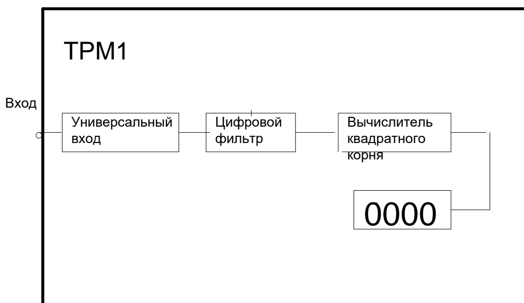
Рис. 3 Структурная схема прибора TPM1
