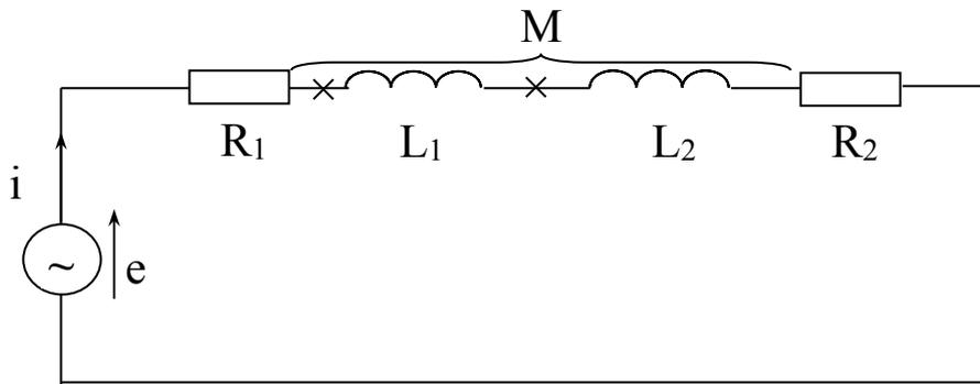
Рисунок 5.1 – Последовательное согласное включение магнитно связанных катушек
