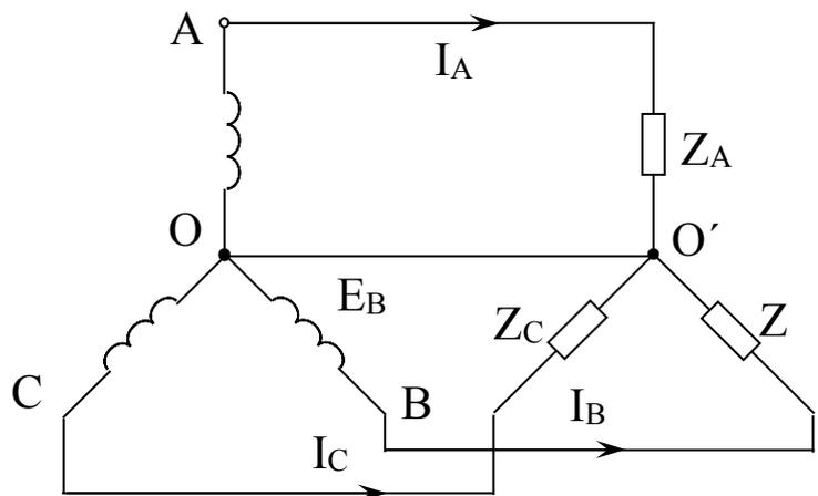
Рисунок 7.2 – Соединение генератора и нагрузки по схеме "звезда – звезда" с нулевым проводом.
