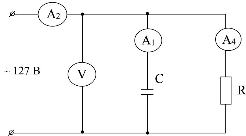
Рисунок 4.3 – Цепь с параллельным соединением резистора и конденсатора
