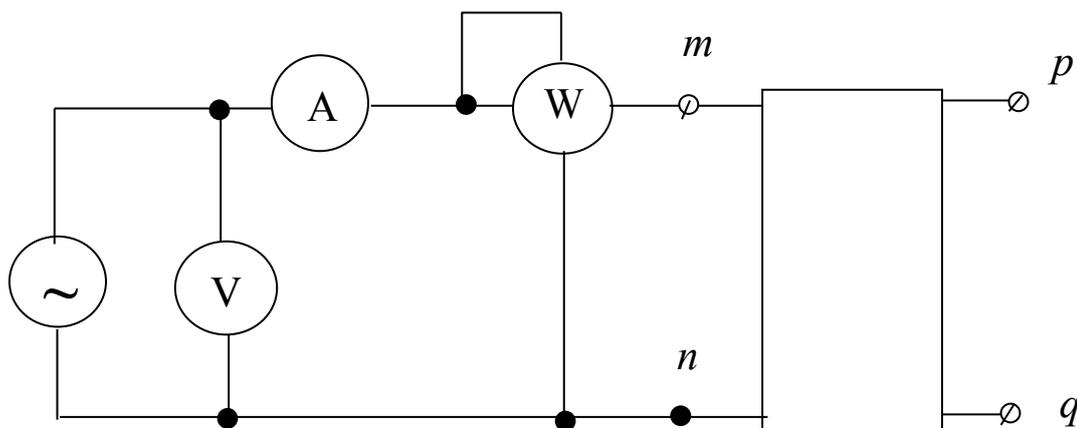
Рисунок 6.3 – Схема для определения входных сопротивлений четырехполюсника
