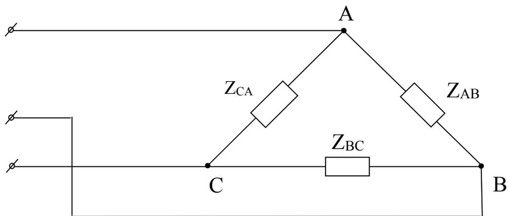
Рисунок 8.1 – Соединение трехфазной нагрузки в треугольник
