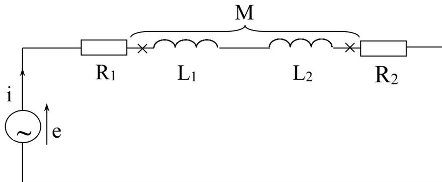
Рисунок 5.2 – Последовательное встречное включение магнитно связанных катушек
