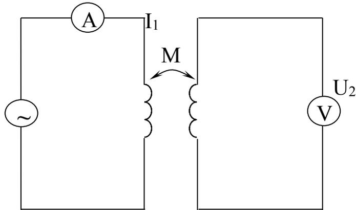
Рисунок 5.3 – Схема включения катушек для определения  $M$
