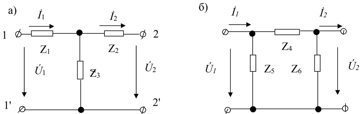
Рисунок 6.2 – Т- и П-образная схемы замещения четырехполюсника
