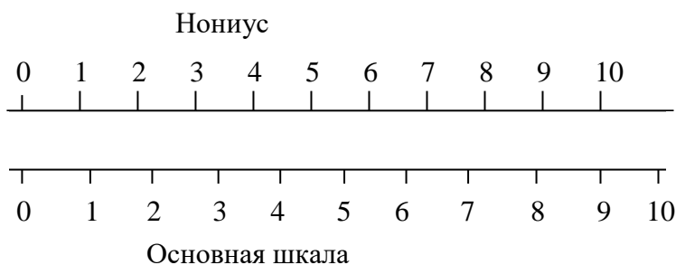
Рисунок 2.1 – Нониус и основная шкала
