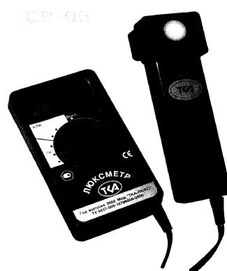
Рисунок 5 – Люксметр ТКА – ЛЮКС
