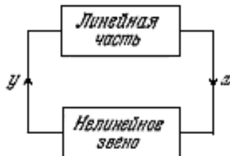
Рисунок 18 — Структурная схема нелинейной АСР
