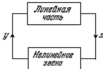
Рисунок 18 — Структурная схема нелинейной АСР
