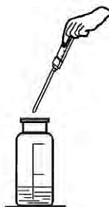
Рисунок 9. Соединение шприца-дозатора с пипеткой для титрования
