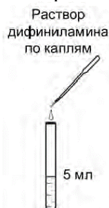
Рисунок 7. Обнаружение нитрат-ионов в исследуемой пробе воды
