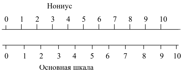
Рисунок 2.1 – Нониус и основная шкала
