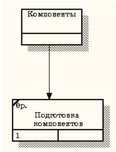
Рисунок 7.9 - Объект ссылки и работа **"Подготовка компонентов"** связаны стрелкой
