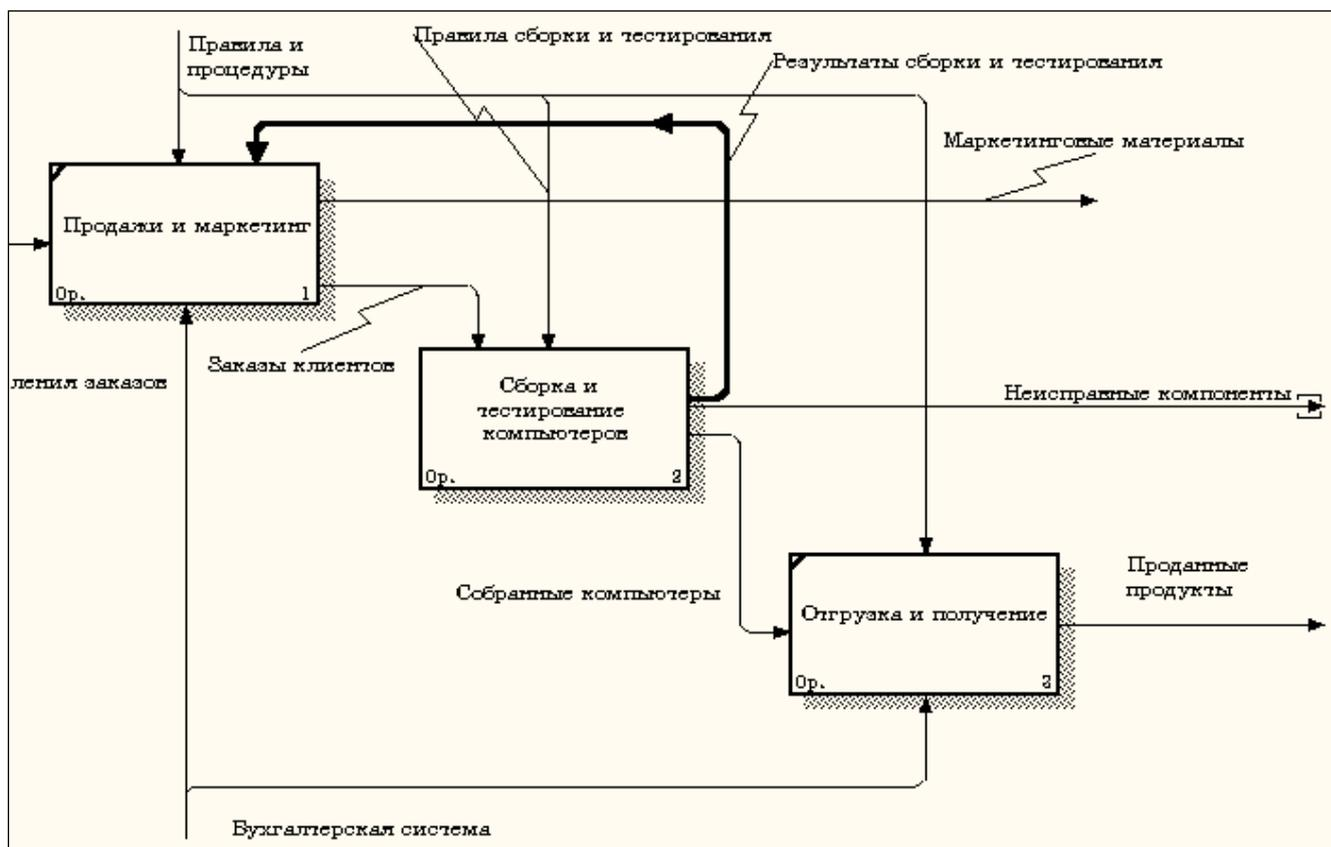
Рисунок 6.9 - Исчезла стрелка вызова "Сборка и тестирование компьютеров"
