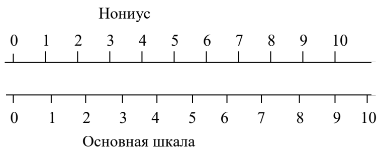
Рисунок 2.1 – Нониус и основная шкала
